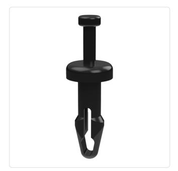
Bautyp: lösbar UL94-V2 Brennbarkeitsklasse: Farbe: schwarz Kopfdurchmesser [mm]: 4.8 Kopfhöhe [mm]: 1.5 Länge [mm]: 8.8 PA 6.6 Material: Materialgruppe: Kunststoff Montagebohrung Bereich [mm]: Ø 2,5-2,6 Nietdurchmesser [mm]: 2.5 Stärke Montageplatte [mm]: 4,1-4,6
