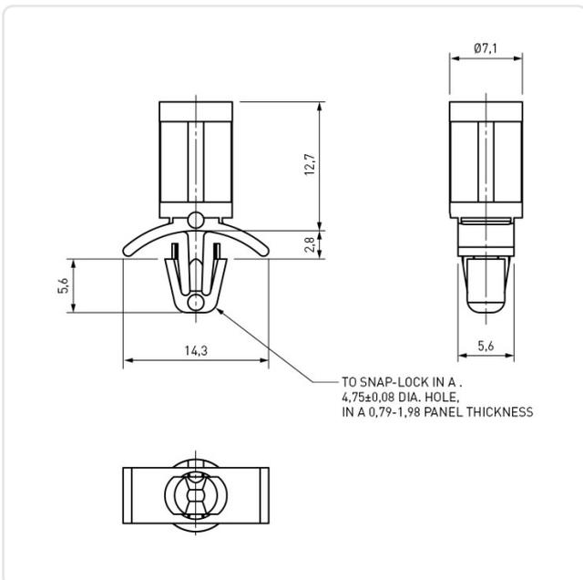
Bohrung Montageplatte [mm]: 4.8
