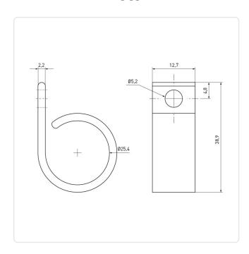
Bohrung [mm]: 5.2 Breite [mm]: 12.7 Brennbarkeitsklasse: UL94-V2 Bündeldurchmesser [mm]: 25,4 Farbe: natur Länge [mm]: 38.9 PA 6.6 Material: Materialgruppe: Kunststoff Stärke [mm]: 2.2
