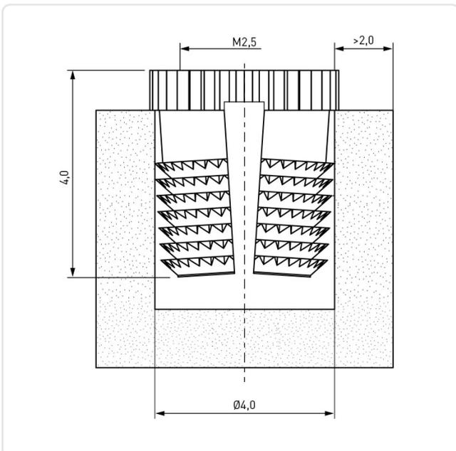
Bohrung Montageplatte [mm]: 4
