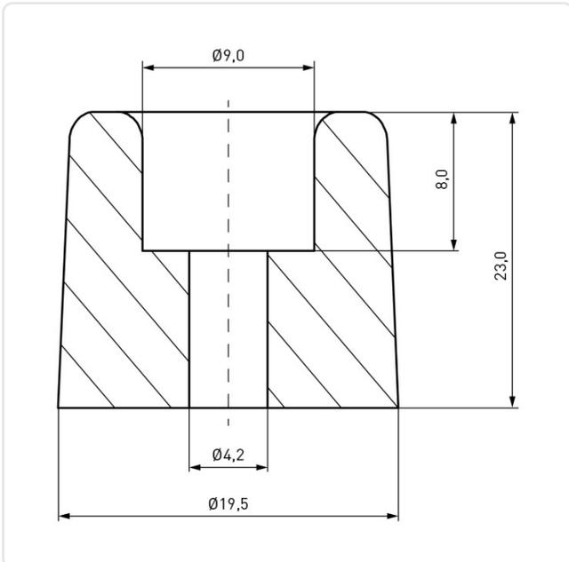
Bohrung [mm]: 4.2
