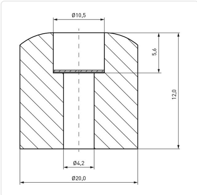
Bohrung [mm]: 4.2
