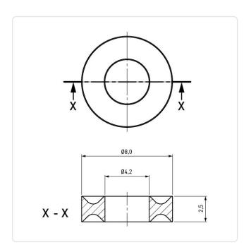
Außendurchmesser [mm]: 8 Für Gewinde: M4 Höhe [mm]: 2.5 Innendurchmesser [mm]: 4.2 Material: PA 6.0 Kunststoff Materialgruppe:
