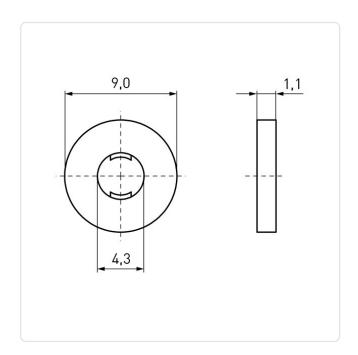
Außendurchmesser [mm]: 9 Farbe: rot Für Gewinde: M4 Höhe [mm]: 1.1 Innendurchmesser [mm]: 4.3
