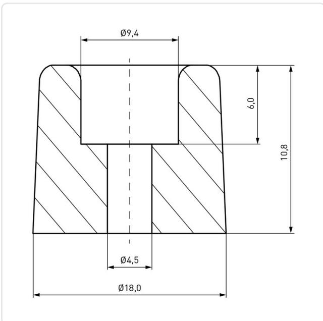
Bohrung [mm]: 4.5
