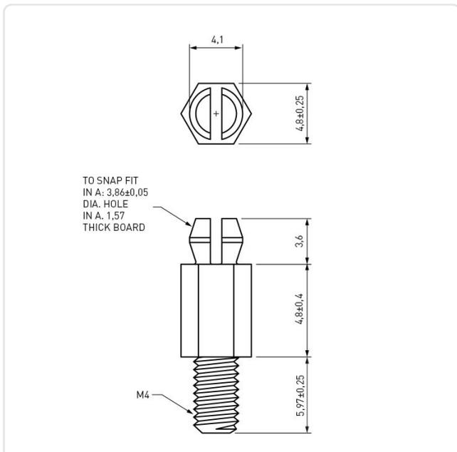
Bohrung Leiterplatte [mm]: 3.9
