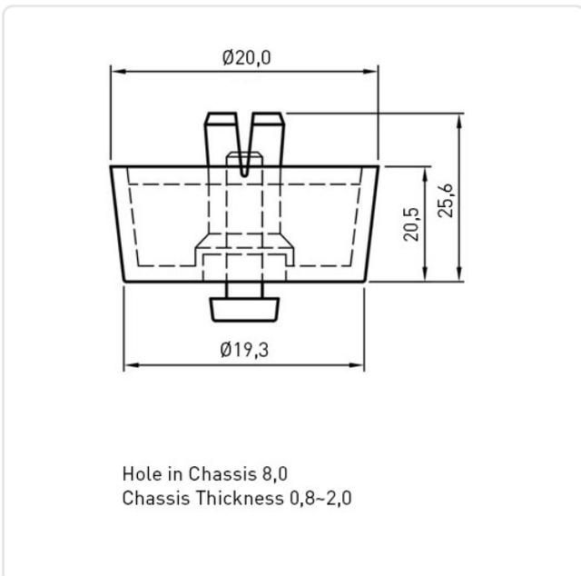
Bohrung Montageplatte [mm]: 8
