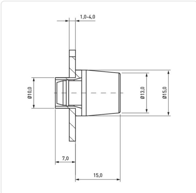
Bohrung Montageplatte [mm]: 10
