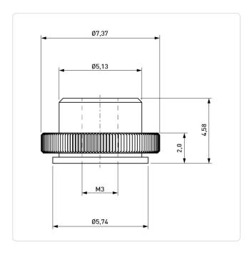
Außendurchmesser [mm]: 7.37 Bohrung Montageplatte [mm]: 5.8
