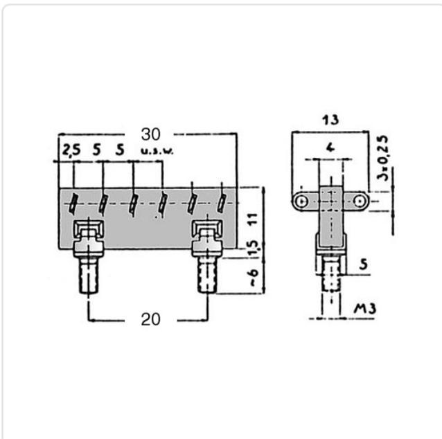
Bohrung Leiterplatte [mm]: 3,2
