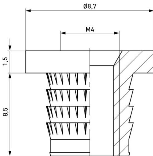
Bohrung Montageplatte [mm]: 5.9
