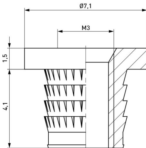
Bohrung Montageplatte [mm]: 4
