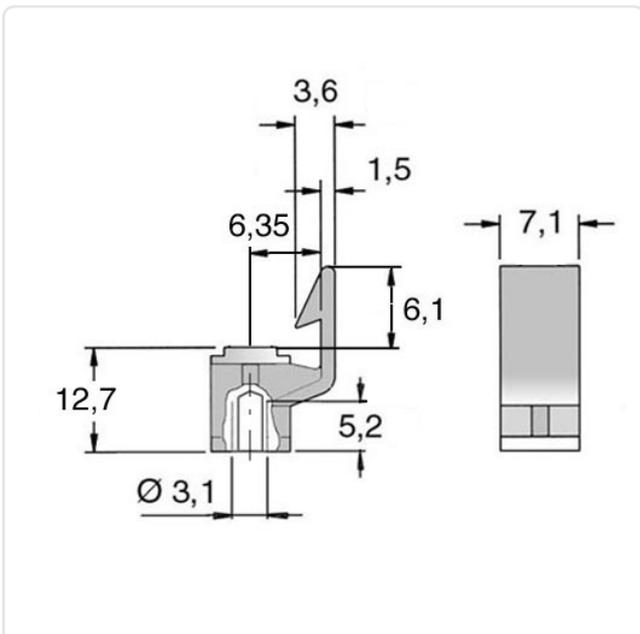
Bohrung Montageplatte [mm]: 3.1
