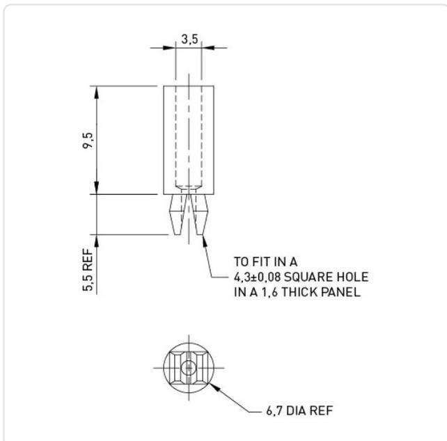
Bohrung Montageplatte [mm]: 4.3
