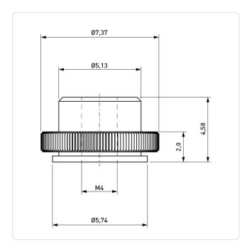
Außendurchmesser [mm]: 7.37 Bohrung Montageplatte [mm]: 5.8
