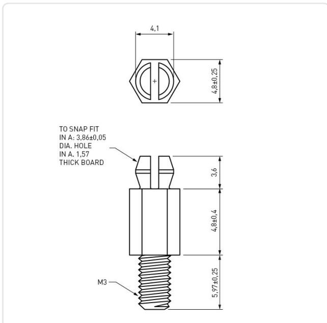
Bohrung Leiterplatte [mm]: 3.9
