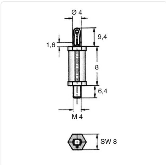
Bohrung Leiterplatte [mm]: 4
