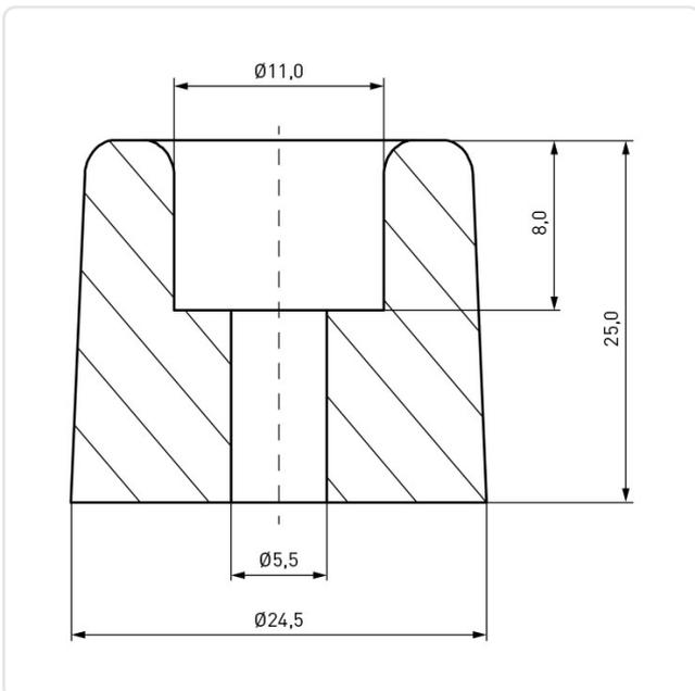
Bohrung [mm]: 5.5
