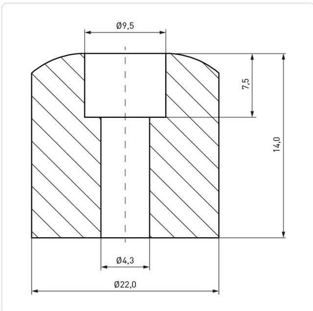
Bohrung [mm]: 4.3
