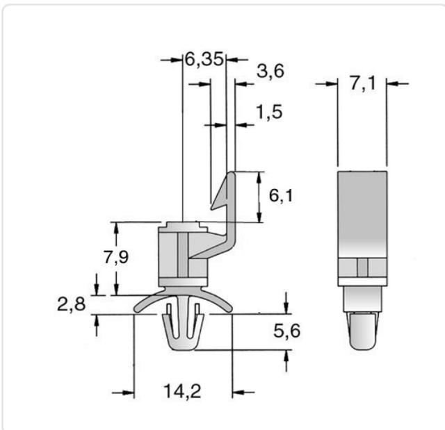
Bohrung Montageplatte [mm]: 4.8
