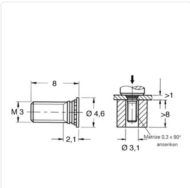
Bohrung Montageplatte [mm]: 3
