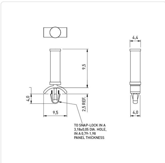
Bohrung Montageplatte [mm]: 3.2
