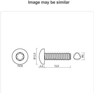
Actuator Size: Torx T30 DIN/ISO: DIN7500-C Drive Type: TORX
