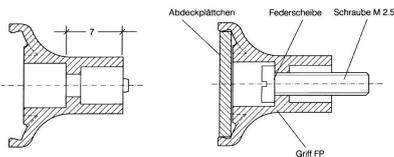
Schnitt durch den Griff zur Ermittlung der Länge der Befestigungsschraube M 2.5
